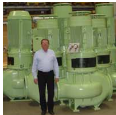
Store vertikale in-line centrifugalpumper – DSL – 4000 m 3 /h til skibe, vand- og varmeværker
