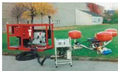
Færdige ”power packs” der kan flyttes til eller anbringes på særlige udsatte steder for oliespild, så alt er parat. Motor, skimmer, pumpe og booms.
