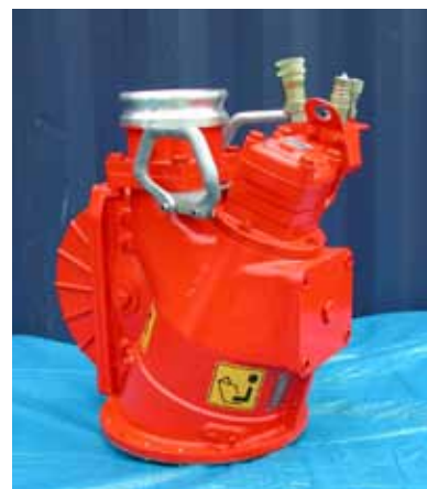
Pumpen er en vertikal Arkimedes skrue-pumpe der ”skruer” den tyktflydende olie gennem pumpen. Om nødvendigt blandet med isklumper i arktisk farvand.
