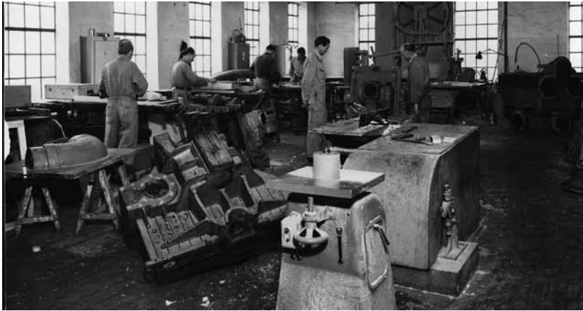
Modelsnedkeriet med træmodeller for støbeforme til de mange forskellige støbesager. Clausen foto o. 1958.
