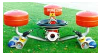
Her ses en ”skimmer” inden brug. De røde beholdere er pontoner der holder pumpen i midten flydende.
