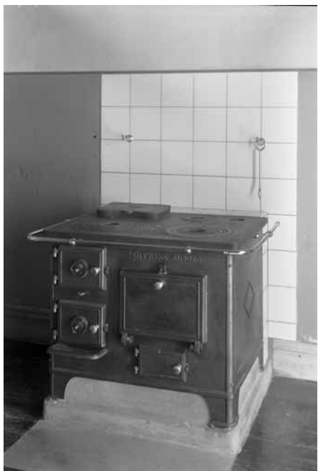
En række særlige produkter opstod under 1940'ernes mangelsituation. Øverst en "kartoffelkoger" på damp, nederst det særlige "sparekomfur" der kunne opvarmes med tørv og lignende dårlige opvarmningsmidler. Foto Fritz Karner, 1941.
