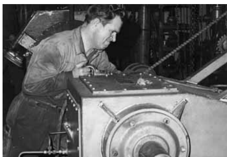
Maskinarbejder Tage Mølgaard arbejder med en briketpresse der ligeledes var et hovedprodukt.
