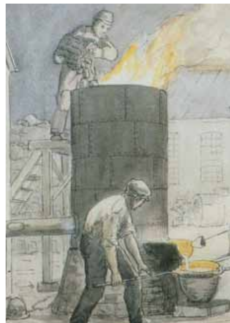
Kupolovn på "Det Smithske Jernstøberi". Foroven hældes råjern, cinders og koks, mens der forned blæses luft ind fra venstre, mens det flydende støbejern tappes til højre. Akvarel fra 1871.
