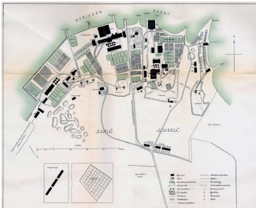
Grundplan over fabrikkene Cimbría og Dania 1890. Med de lange rækker af bundfældningsbassiner og tørrehylder bredte de to fabrikkers sig over et meget stort areal.
