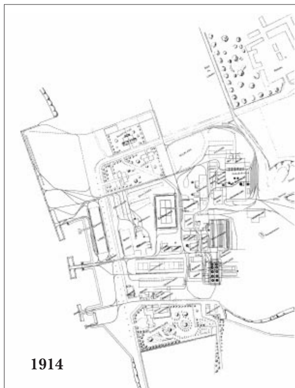
Grundplaner over Aalborg Portland 1890-1973. Fabrikkens pladskrav var stabile frem til 1950'erne, hvorefter monteringen af en række nye roterovne fordoblede anlæggets areal.
